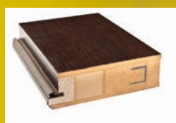
Skrzydło o grubości 46 mm z uszczelką, ramiaki drewniane wzmocnione ceownikiem stalowym gr. ścianki 2 mm, wypełnienie płyta pełna.
