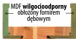
MDF wilgocioodporny obłożony fornirem dębowym ramiak sosnowy obłożony HDF wilgocioodpornym i fornirem dębowym
