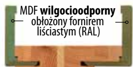
MDF wilgocioodporny obłożony fornirem liściastym (RAL) ramiak sosnowy obłożony HDF wilgocioodpornym i fornirem liściastym (RAL)
