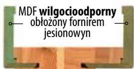
MDF wilgocioodporny obłożony fornirem jesionowym ramiak sosnowy obłożony HDF wilgocioodpornym i fornirem jesionowym
